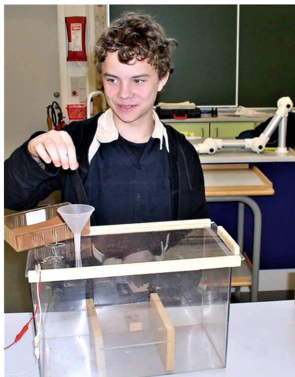
Magnetisk støv drysses ned i et terrarium, hvor en mølle blæser støv rundt. En del af støvet fanges på en magnet, hvilket illustrerer, hvordan de danske magnetter på roverne Spirit og Opportunity fanger luftbårent støv på Mars.
